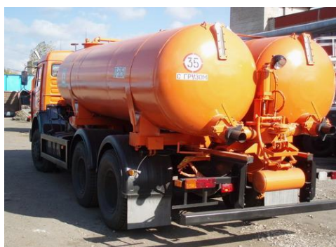
Рис. 5.3. Вакуумная машина КО-505А на шасси КамАЗ-65115-71
