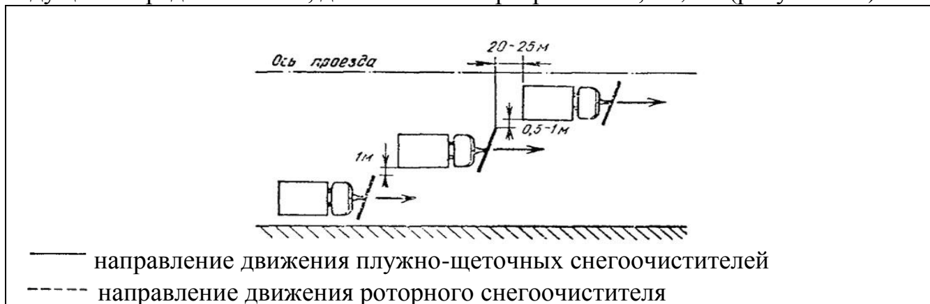
Рис. 8.5. Схема расчистки проезжей части улиц колонной плужно-щеточных снегоочистителей и складирование снега в лотке
