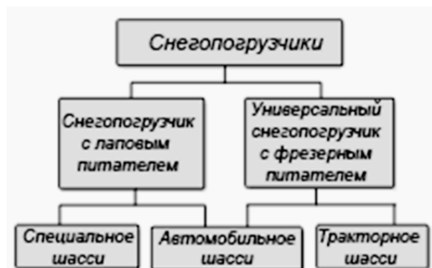
Рис. 8.16. Классификация снегопогрузчиков
