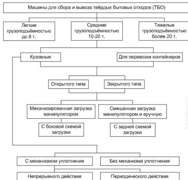
Рис. 4.29. Классификация машин для сбора и вывоза ТБО
