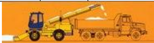
Рис. 8.22. Схема погрузки снега традиционным способом
