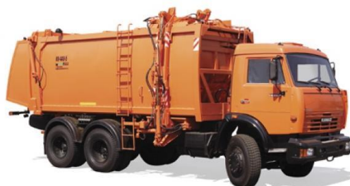
Рис. 4.32. Мусоровоз с боковой загрузкой КО-440-5 на базе шасси КАМАЗ 65115
