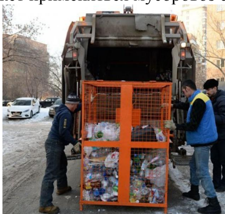
Рис. 4.4. Погрузка содержимого спецконтейнера в мусоровоз с задней загрузкой
