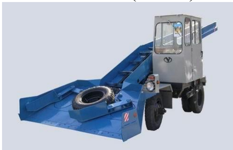
Рис. 8.21. Лаповый снегопогрузчик КО-206.
