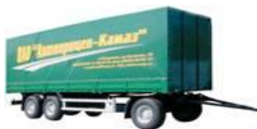
Рис. 4.12. Тентовый прицеп бортовой СЗАП 8353
