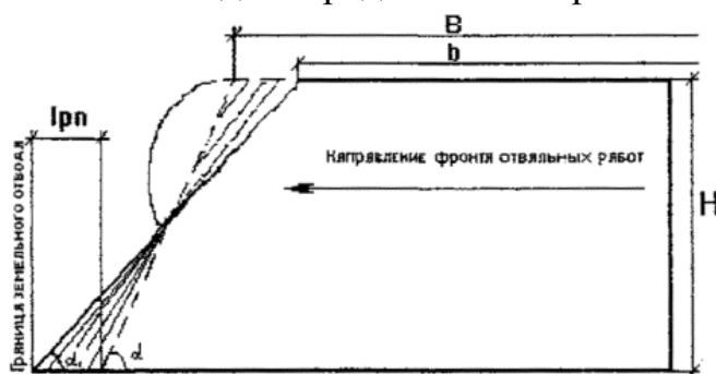
Рис.4.37. Технологическая схема выполаживания откоса свалок
