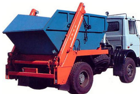
Рис. 4.34. Бункеровоз МКС-3501 на шасси МАЗ-5551А2
