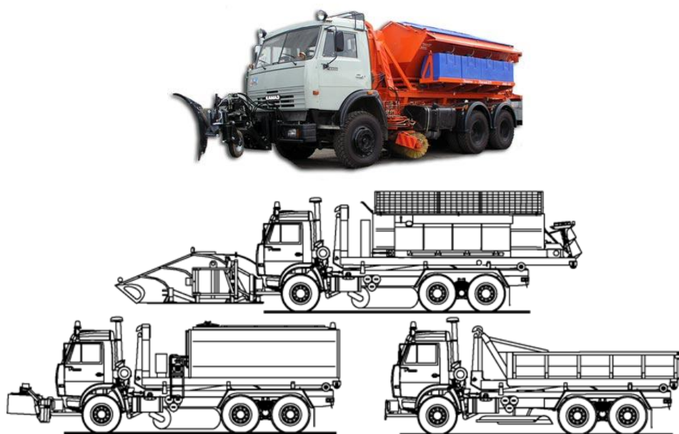
Рис. 6.20. Комбинированная машина МКДС-4107.
